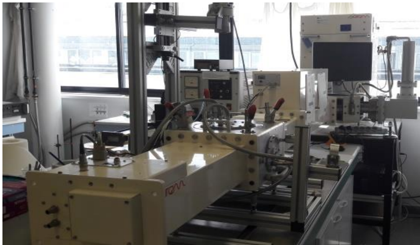
Figure II-6 - Photographie du micro-ondes monomode à 915 MHz automatisé Laboratoire CRISMAT
