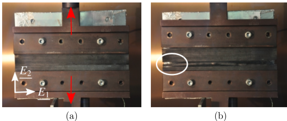
Figure 2.6 – Photographies d'un essai de traction transverse plane sur un empilement de 4 plis pré-imprégnés UD carbone/époxy de même orientation : état initial (a) et courant (b) [33] – la direction de sollicitation est indiquée en rouge, et le phénomène de décohésion est mis en évidence.
