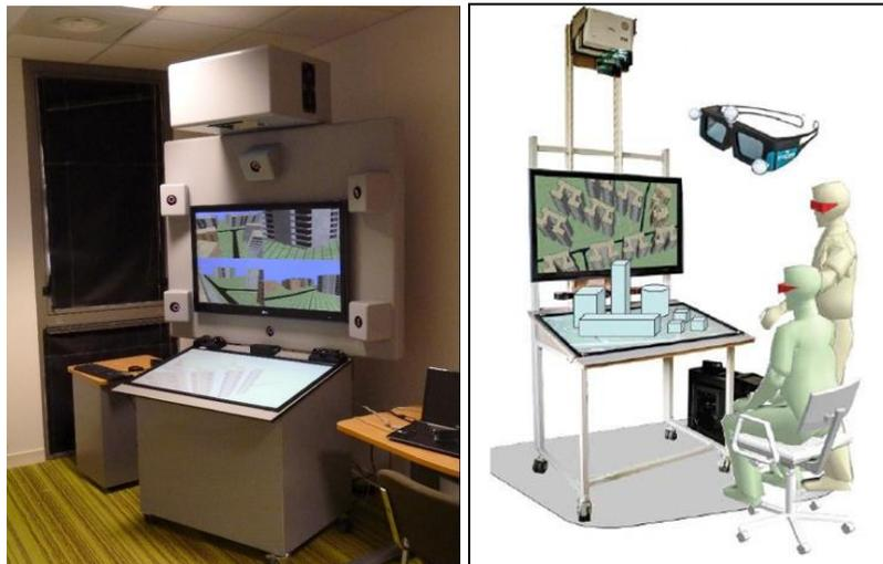
**Figure 12. Le 3DC21, un système interactif multi-opérateur multi-vues**
