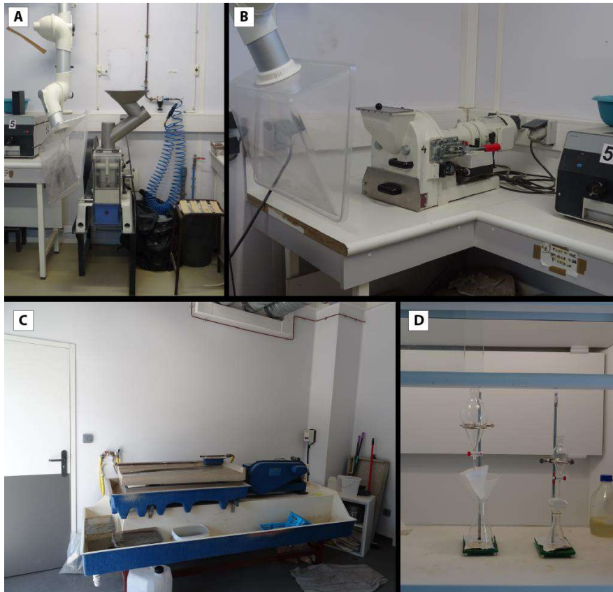
Figure 1: Ensemble des appareils utilisés lors du broyage et de la séparation minéral. A : broyeur à mâchoires pour le premier concassage grossier des échantillons, B : broyeur à disque pour le broyage fin avant tamisage à 500µm, C : table à secousse, D : séparation minérales aux liqueurs dense
