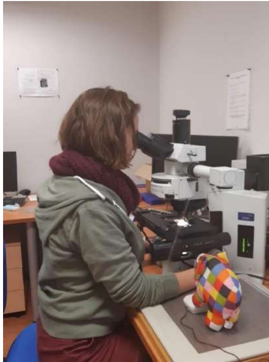
Figure 2: Dispositif de comptage des traces de fission (opérateur : Juliette Rat, assistée par Elmer)
