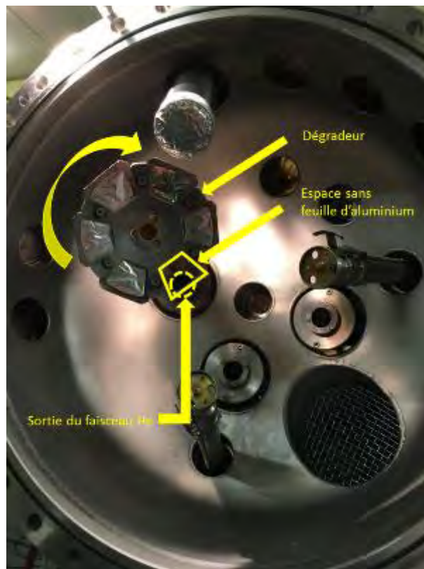
Figure II-14: Chambre 3F de Jannus avec le dégradeur installé en regard de la sortie du faisceau He.
