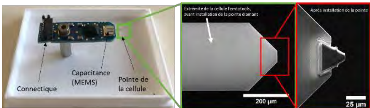
Figure II-25 Dispositif Femtotools pour la mesure de charge lors des essais de microcompression
