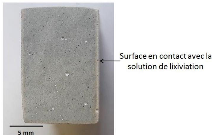
Figure 90 : Photographie de l'échantillon coupé après 6 mois de lixiviation semi-dynamique à l'eau ultra pure
