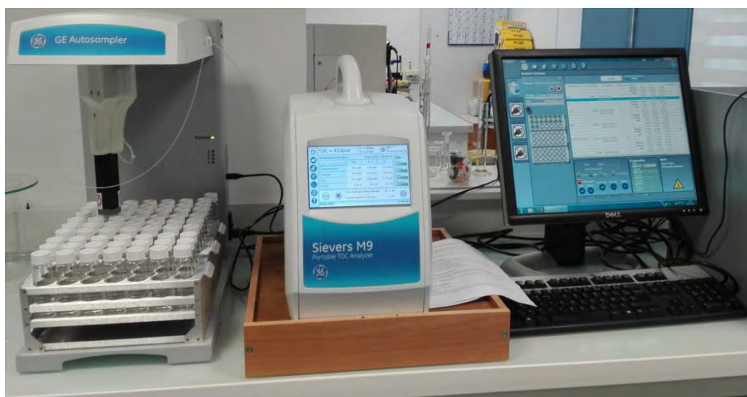
Figure II. 27: Illustration présentant l'ensemble du système d'analyse du WSOC : le passeur d'échantillons automatique (GE Autosampler), des analyseurs COT Sievers M9 et M9e et le support du logiciel d'acquisition (Logiciel Sievers DataPro2) (LA).
