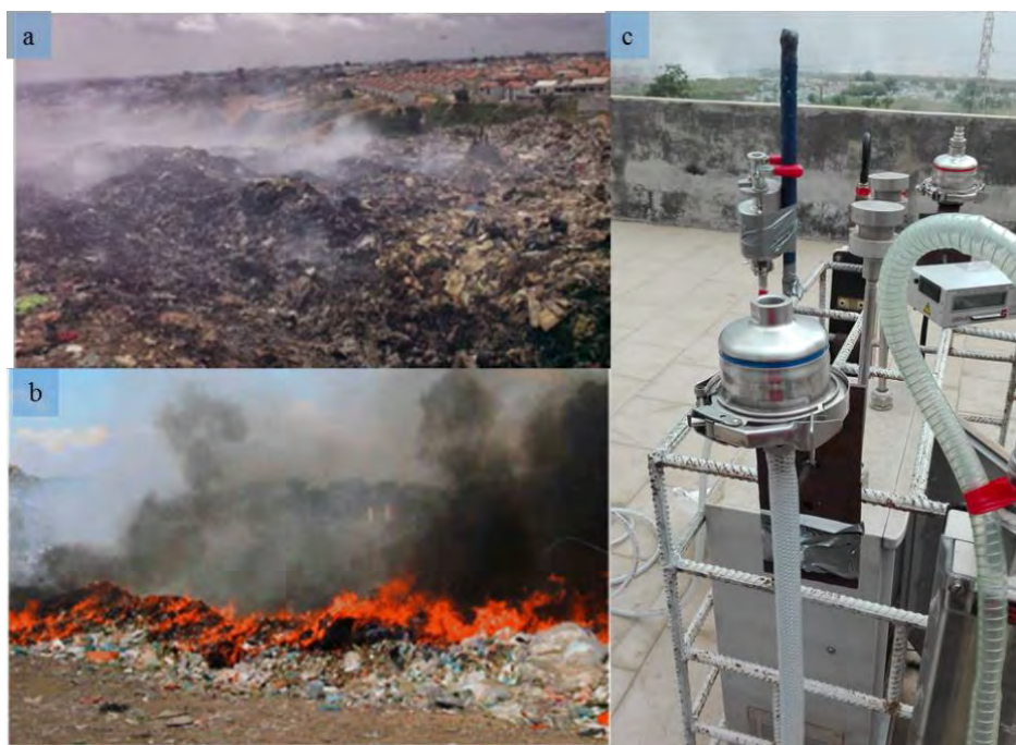
Figure II. 7: Site feux de décharge (décharge d'Akouédo). Avec a) une vue d'auto-combustion de biomasse au centre de la décharge, b) une vue de combustion de biomasse à l'entrée, et c) une vue de coffret de mesure d'aérosol sur le toit d'un bâtiment à proximité de la décharge fumant.
