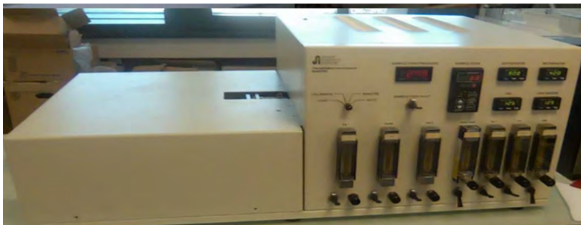
Figure II. 21: Illustration de l'analyseur de carbone suivant la méthode thermo-optique (DRI).
