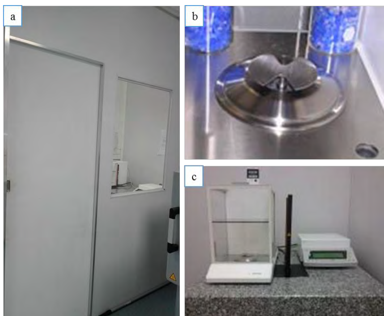
Figure II. 16: Microbalance Sartorius (modèle MC21S, de précision 1\mu\text{g} ) utilisée pour la pesée des filtres, avec a) une vue de la salle thermostatée, b) une vue du plateau de la balance et une vue c) de la microbalance équipée d'un champ U pour éliminer les charges électrostatiques.
