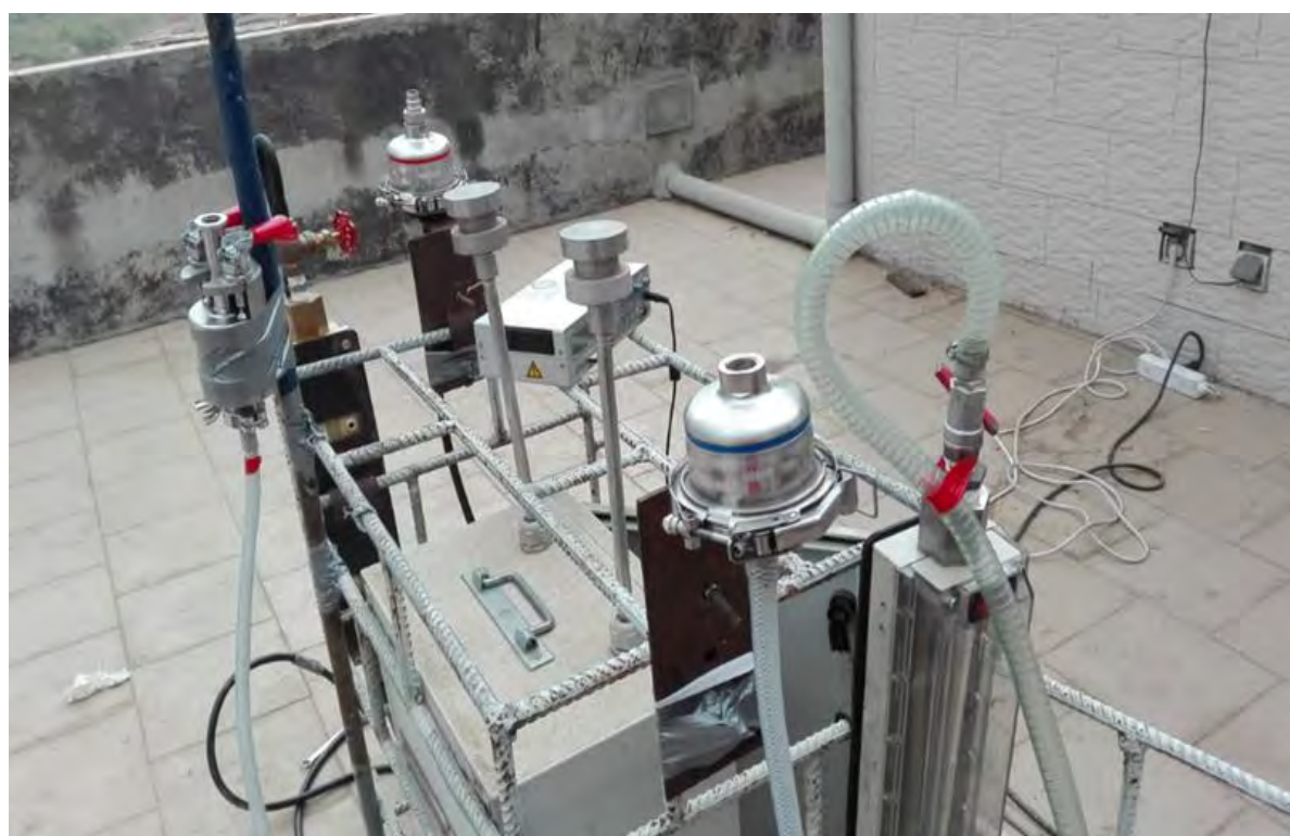
Figure II. 11: Station de prélèvement avec les trois impacteurs en parallèle
