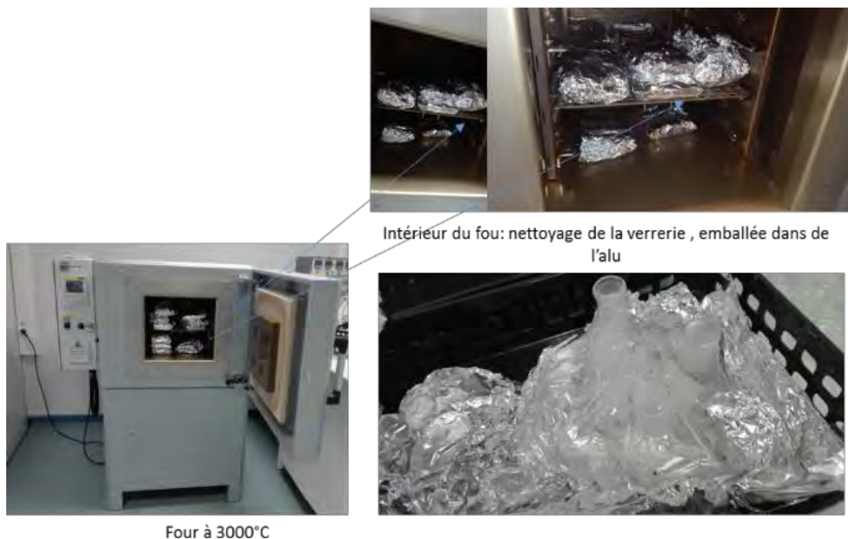
Figure II. 29: Illustration présentant le four Nabertherm, programmateur, muni d'une commande, et d'un afficheur LCD destinée à l'analyse du WSOC, ce schéma indique des erlens calcinés à l'intérieur du four (LA).
