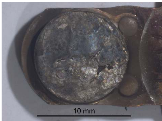
Figure B.74 – Surface de la pastille L1M du contacteur 4.
