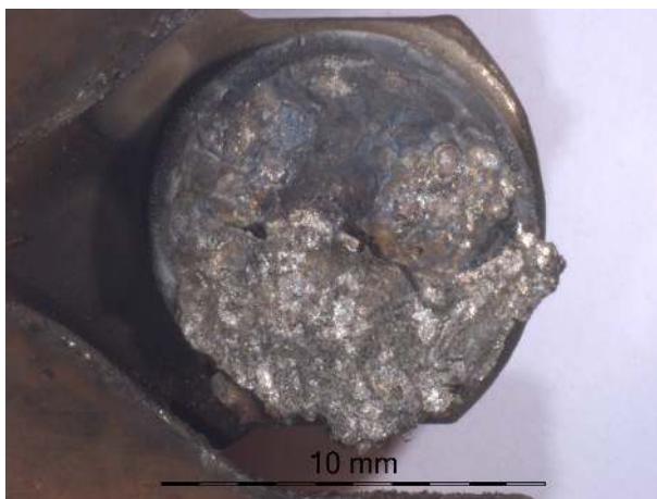
Figure B.85 – Surface de la pastille L1F du contacteur 5.
