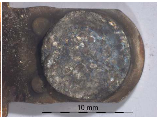
Figure B.68 – Surface de la pastille T1M du contacteur 3.
