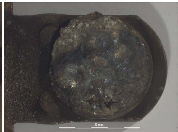
Figure B.116 – Surface de la pastille T1M du contacteur 7.
