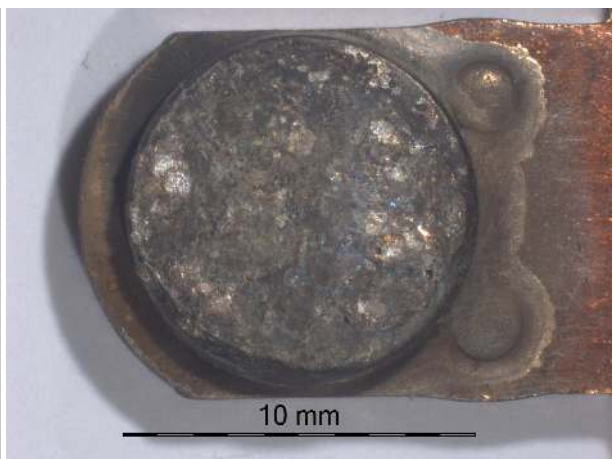
Figure B.50 – Surface de la pastille L1M du contacteur 2.
