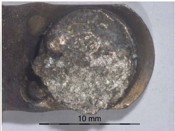
Figure B.48 – Surface de la pastille T3M du contacteur 1.
