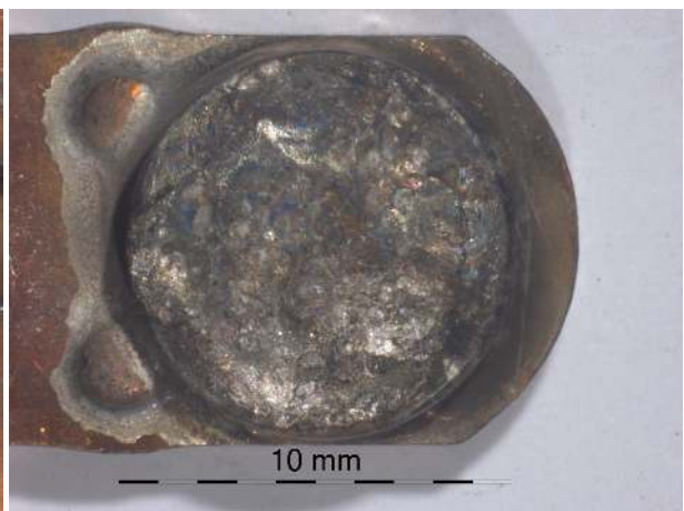
Figure B.44 – Surface de la pastille T1M du contacteur 1.
