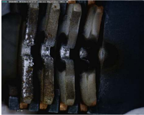
Figure 3.39 – Photographie des ailettes d'un des produits après les essais sur banc AC-3 de 400 000 cycles de fermeture (600 A) et ouverture (100 A).
