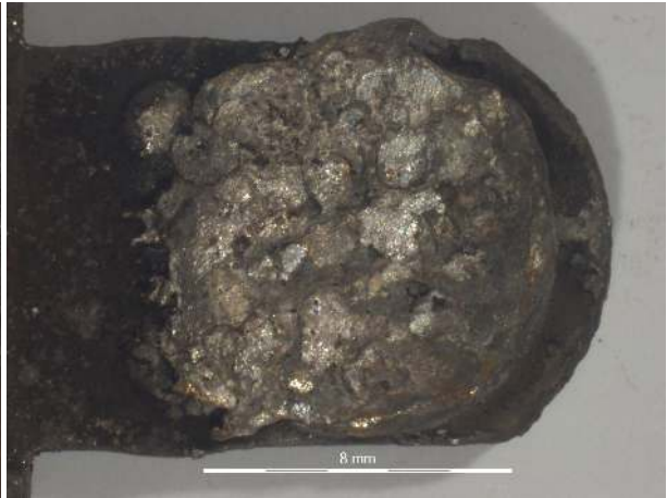
Figure B.118 – Surface de la pastille T2M du contacteur 7.
