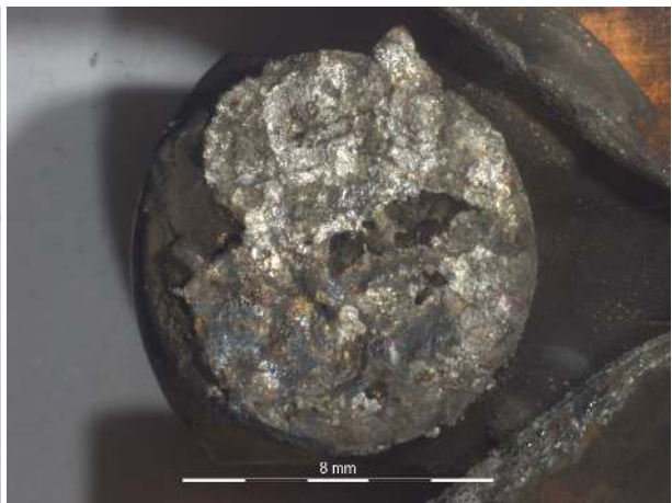
Figure B.152 – Surface de la pastille T2F du contacteur 10.
