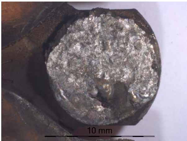
Figure B.89 – Surface de la pastille L3F du contacteur 5.
