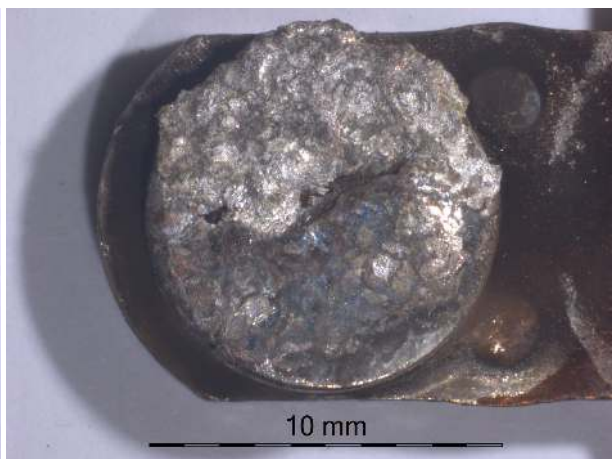
Figure B.86 – Surface de la pastille L1M du contacteur 5.
