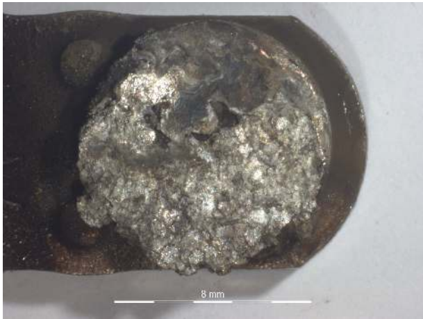
Figure B.155 – Surface de la pastille T3M du contacteur 10.
