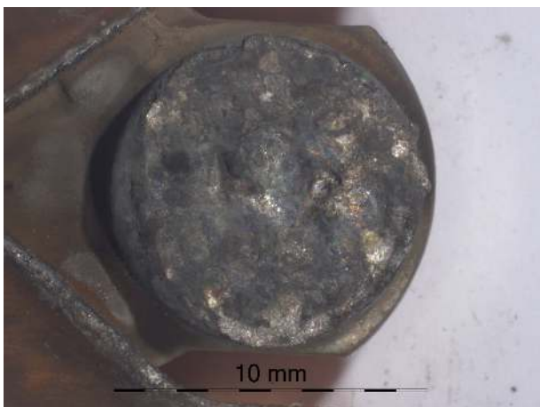
Figure B.61 – Surface de la pastille L1F du contacteur 3.
