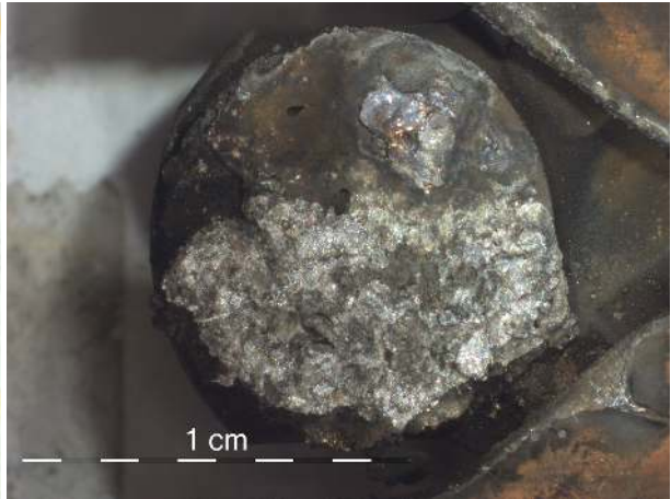
Figure B.130 – Surface de la pastille T3F du contacteur 8.
