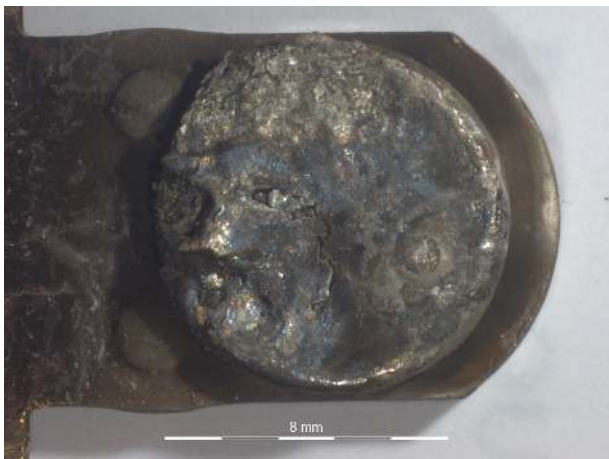
Figure B.151 – Surface de la pastille T1M du contacteur 10.
