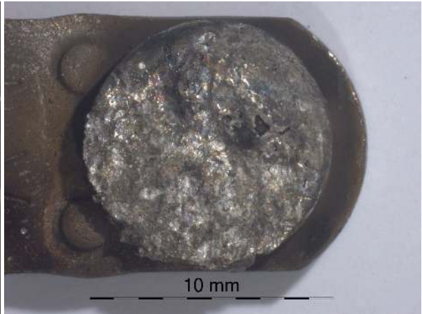
Figure B.82 – Surface de la pastille T2M du contacteur 4.
