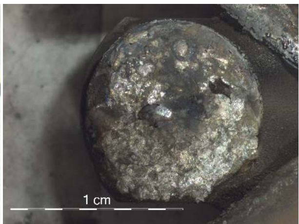
Figure B.128 – Surface de la pastille T2F du contacteur 8.
