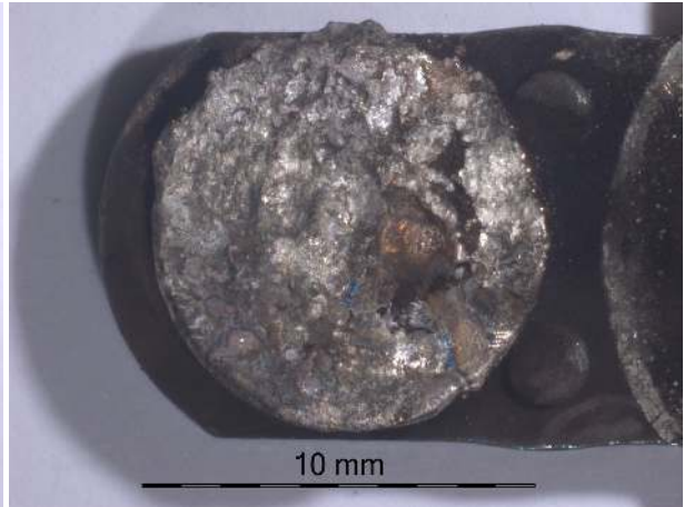
Figure B.88 – Surface de la pastille L2M du contacteur 5.
