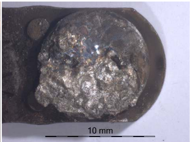
Figure B.96 – Surface de la pastille T3M du contacteur 5.
