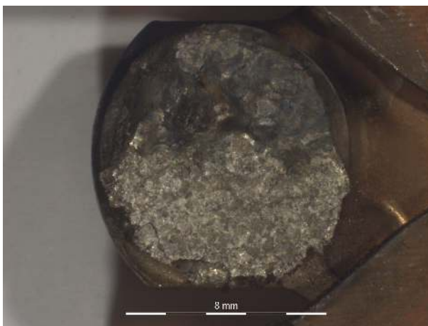
Figure B.103 – Surface de la pastille T1F du contacteur 6.
