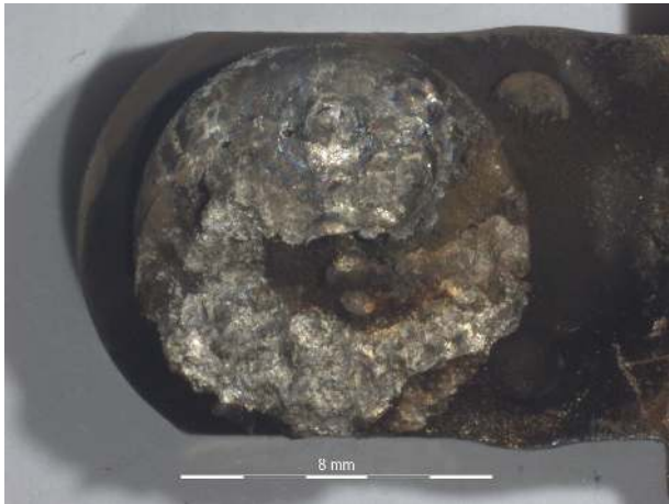
Figure B.149 – Surface de la pastille L3M du contacteur 10.
