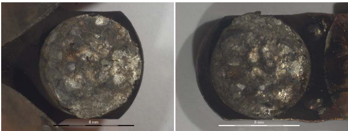
Figure B.109 – Surface de la pastille L1F du contacteur 7.
