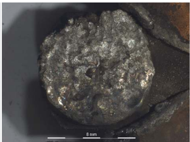
Figure B.140 – Surface de la pastille T2F du contacteur 9.
