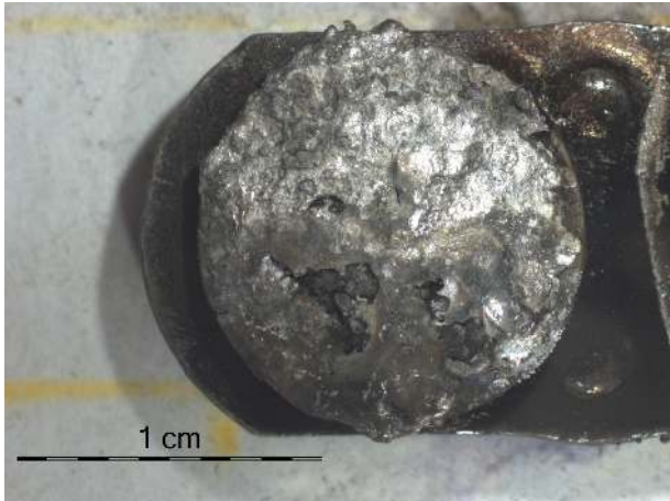
Figure B.123 – Surface de la pastille L2M du contacteur 8.
