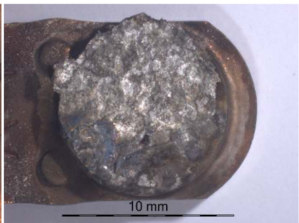
Figure B.92 – Surface de la pastille T1M du contacteur 5.
