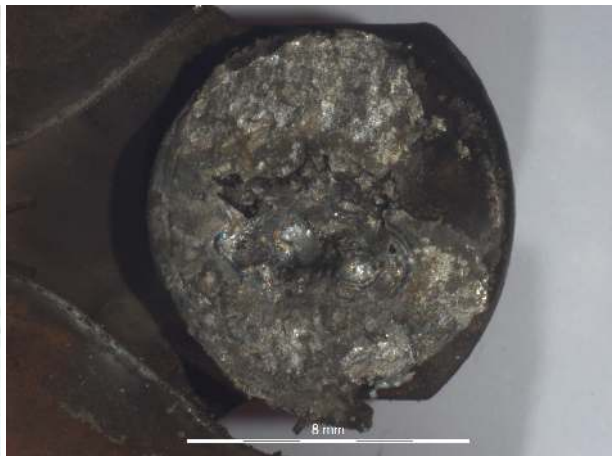
Figure B.132 – Surface de la pastille L1F du contacteur 9.
