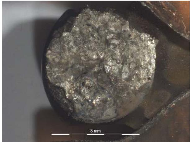
Figure B.154 – Surface de la pastille T3F du contacteur 10.
