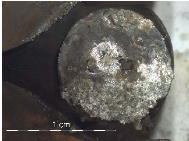
Figure B.124 – Surface de la pastille L3F du contacteur 8.
