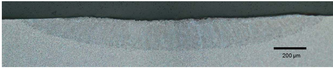
Figure 4.12 – Microstructure dans une section réalisée le long d’un cratère après un arc unique dans le cas d’une cathode – Observation avec un microscope optique.
