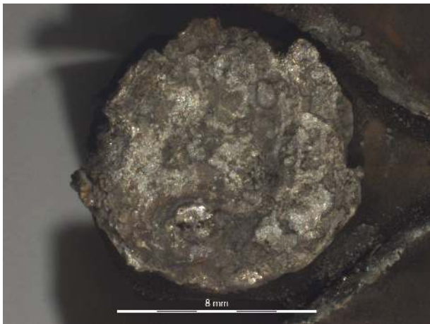
Figure B.119 – Surface de la pastille T3F du contacteur 7.
