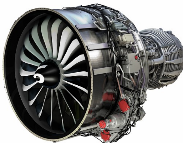
FIGURE 1.2 – Illustration technique 3D d'un moteur LEAP-1A. © 2017 Antonio Gomez / Safran
