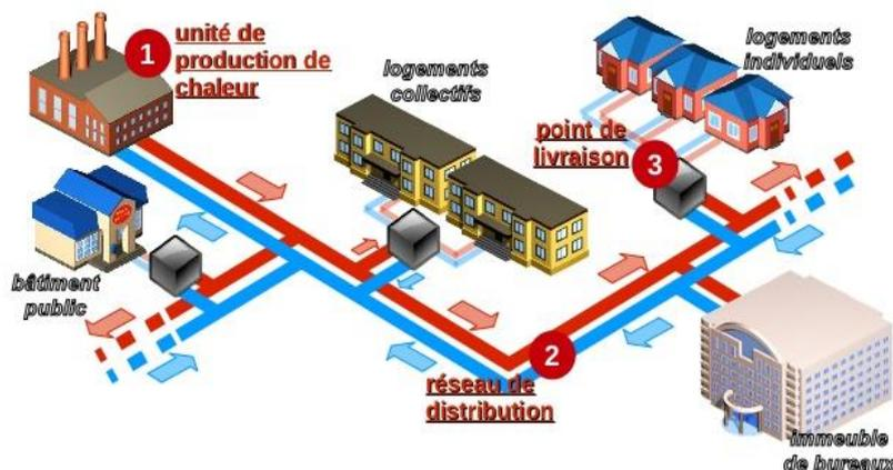
Figure 1-1 Schéma de principe d'un réseau de chaleur (CEREMA, 2016a)
