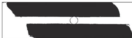
FIGURE 1.19: Propagation du délaminage de l'interface -45^\circ/0^\circ vers les talons [Nixon-Pearson et al. , 2013]
