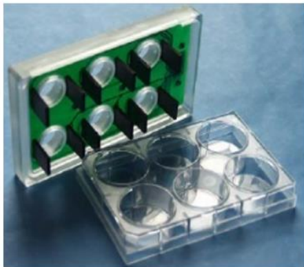
Figure 34 : Dispositif d'électrostimulation cellulaire (Dish, IonOptix, Dublin, Irlande). Montage expérimental du système de contraction des myotubes C2C12. Une (A) plaque à 6 puits contenant une paire d'électrodes de carbone pour chaque puits a été connectée à un (B) générateur d'impulsion électrique.
