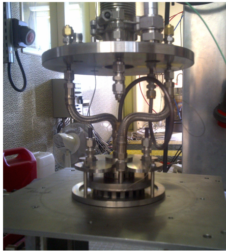
(a) Photo du brûleur monté avec la fleur. (b) Représentation numérique centrée sur la partie plenum.
