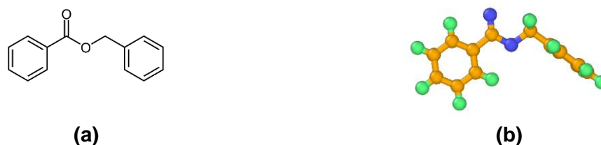
Figure 4. Représentation schématique (a) de la molécule de benzoate de benzyle et (b) de son modèle DM. Dans (b), les particules vertes représentent les atomes d'hydrogène, les oranges les atomes de carbone et les bleues les atomes d'oxygène.
