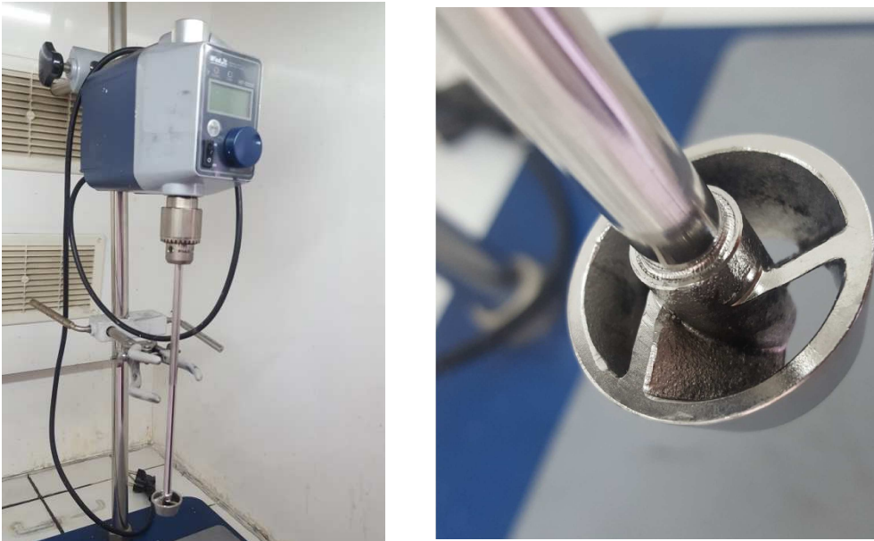
Figure 98 : Images du mélangeur mécanique (à gauche) et de la pale utilisée (à droite)
