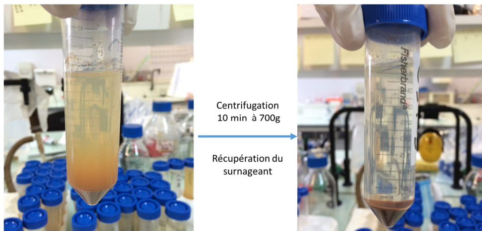
Figure 48 : Lavage du sol et récupération du surnageant.
