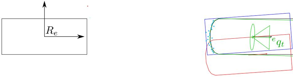
FIGURE 4.7. – *La méthode par optimisation itérative permet de déterminer une nouvelle pose avec sa matrice de covariance, en vert.*
