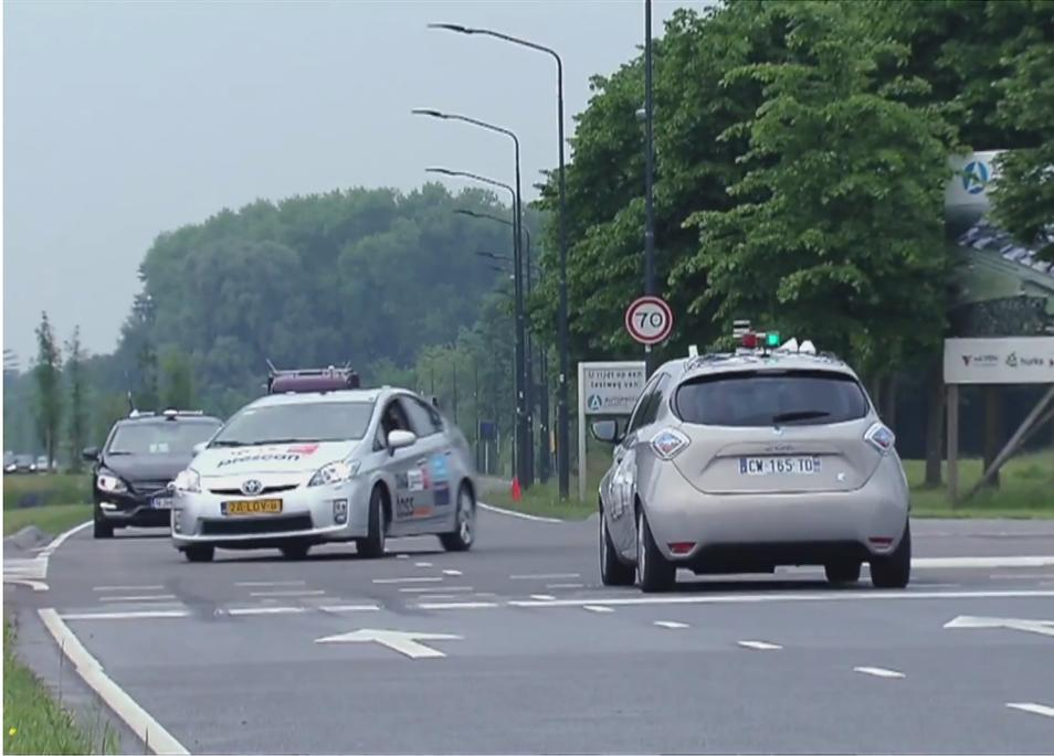
FIGURE 1.2. – *Scénario d’intersection. La Zoe autonome du laboratoire Heudiasyc est visible sur cette photo. La lumière verte allumée sur le toit indiquait aux juges-arbitres du GCDC que la manœuvre se faisant effectivement en mode autonome.*
