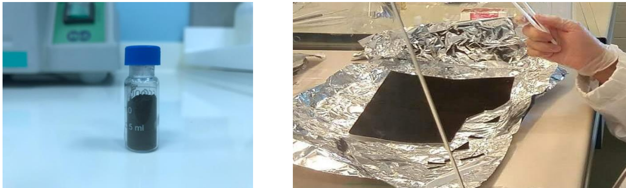
Figure 26 : Échantillons obtenus à la fin du prélèvement : PM_{2.5-0.3} à gauche, et PM_{0.3} sur filtre à droite.
