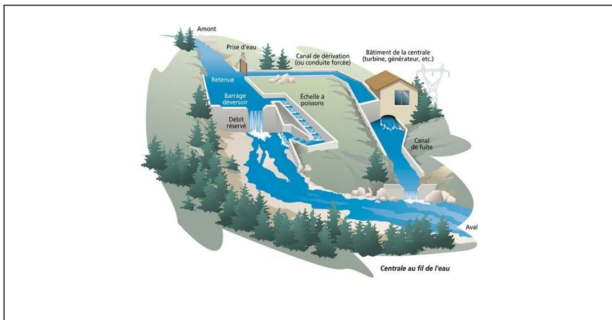
Figure 1.6 Schéma général du fonctionnement d'une micro-centrale hydroélectrique [4]
