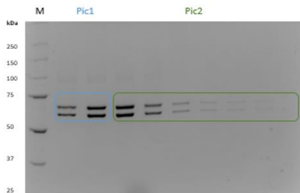
Figure 55 : Seconde étape de purification de KuCC : après passage sur une colonne échangeuse d'anions ResourceQ de 6 mL. En haut : chromatogramme de l'étape de ResourceQ. Signal d'absorbance de l'UV à 280 nm (bleu) et à 260 nm (rouge); conductivité (mS/cm) (marron). On observe deux pics (pics 1 et 2). En bas : gel SDS-PAGE 10 % après Resource Q. La protéine est présente dans les deux pics (pics 1 et 2) avec un meilleur degré de pureté. Dans les fractions les plus chargées, on observe des contaminants sont observés à 100 et 150 kDa.
