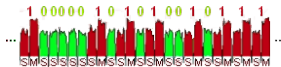
Figure 2.4.: Analyse simple de la consommation d'une exponentiation modulaire. [NEWELL et al. 2013]
