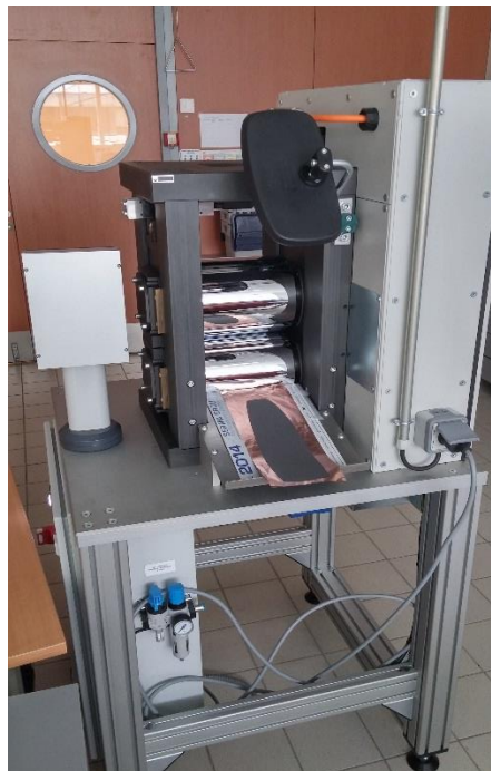
Figure 4.23. Calandreuse utilisée pour régler l'épaisseur finale de l'électrode
