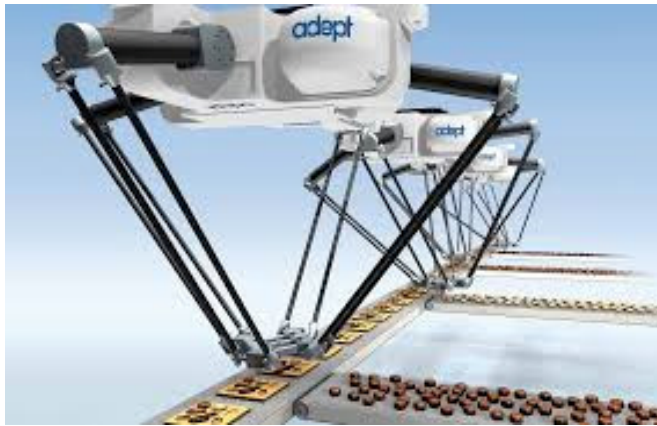
(a) Robot parallèle spatial Adept pour les opérations prise et pause
