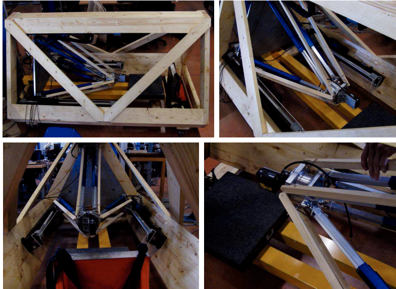
FIGURE 1.13 – Remplacement du châssis du robot par une structure en bois LAURENT et al. [2010a].
