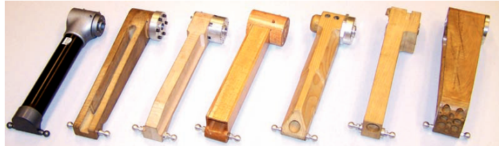
(a) Prototypes de bras avec le bras original en composites de carbone
