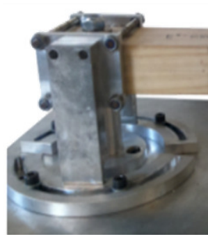
(c) Articulation pivot active (fixe à la base)
