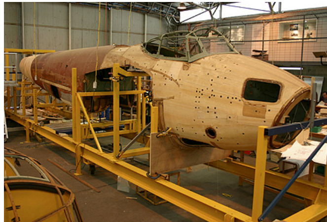
FIGURE 1.10 – Châssis d’avion en bois.
