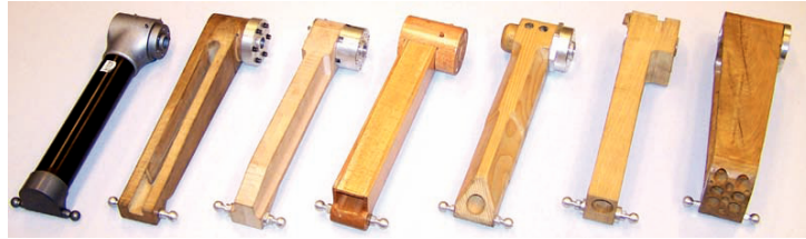
(a) Prototypes de bras avec le bras original en composites de carbone
