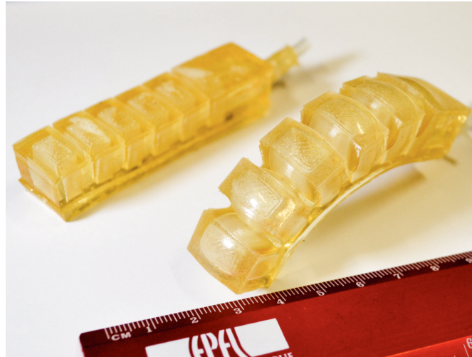
FIGURE 1.9 – Actionneurs en gélatine de porc développés à l'École Polytechnique Fédérale de Lausanne (EPFL) SHINTAKE et al. [2017] .
