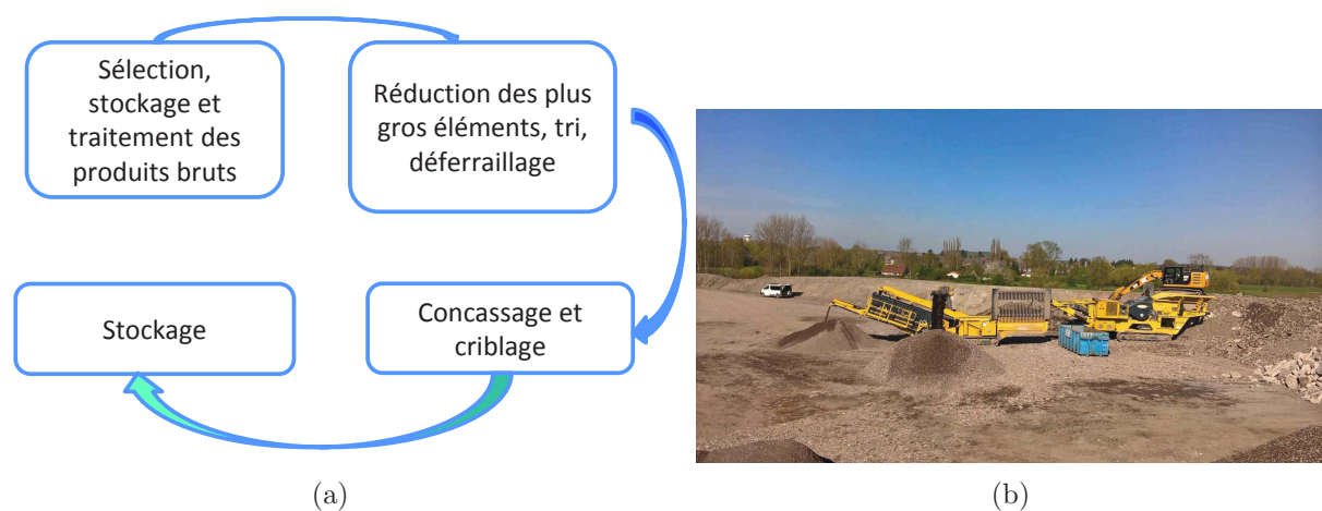
FIGURE 1.3. – (a) Étapes de production des granulats de bétons recyclés. (b) Plateforme mobile de recyclage de l'entreprise Recybtpt.
