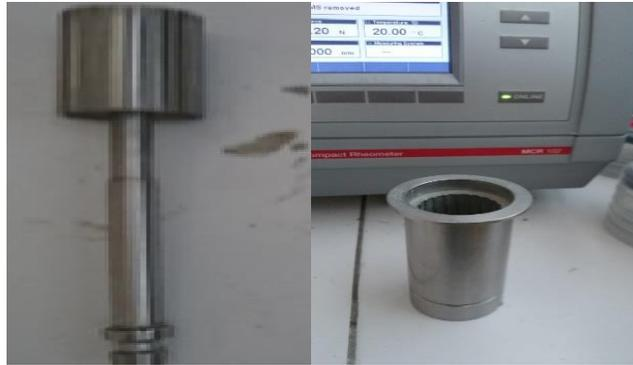
Figure 2- 8 : Géométrie type Couette : mobile et récipient utilisés pour les essais rhéologiques
