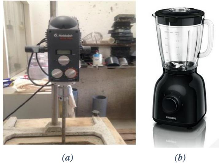
*Figure 2- 1 : Agitateur (a) et blender (b) utilisés pour le malaxage des coulis cimentaires*
