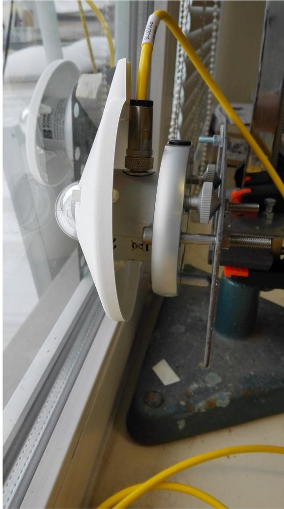
Figure 3.8 : Deux pyranomètres utilisés pour estimer le coefficient de transmission
