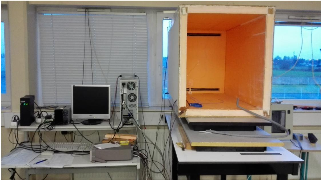
Figure 3.5 : Dispositif de mur Trombe composite à échelle réduite réalisé en laboratoire LGCgE
