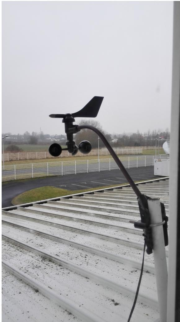
Figure 3.10 : Anémomètre-girouette utilisé pour mesurer la vitesse et la direction du vent
