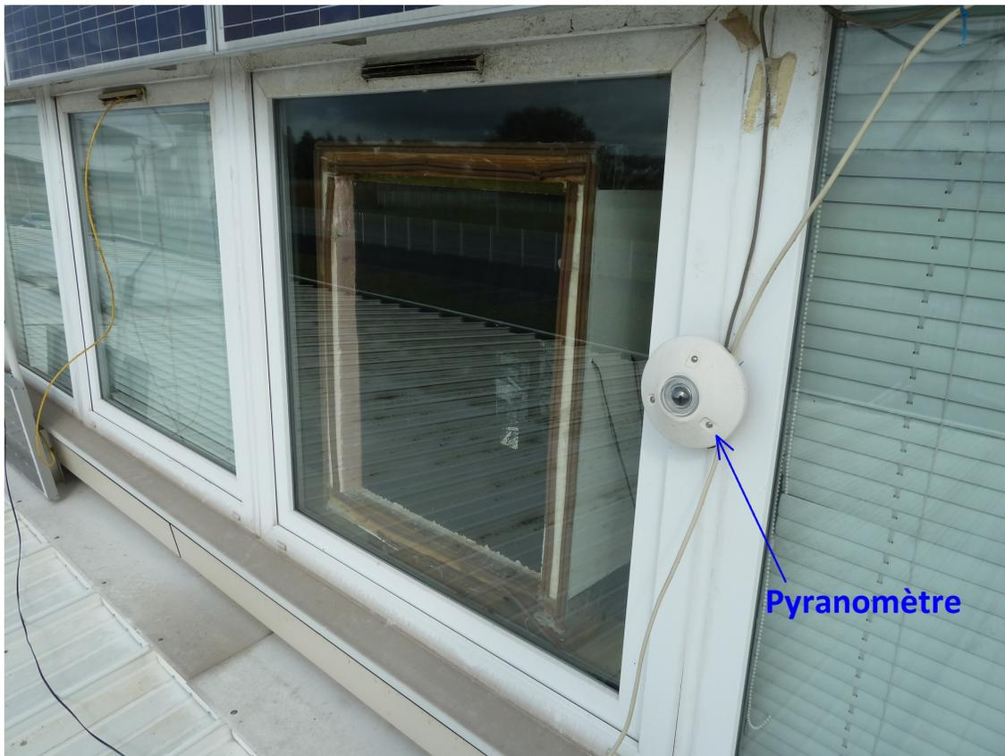
Figure 3.7 : Pyranomètre utilisé pour récupérer le flux solaire global vertical
