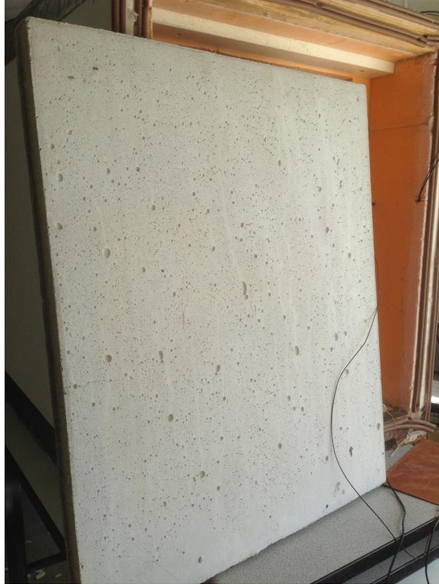
Figure 3.13 : Paroi stockeuse intégrant un MCP fabriquée au laboratoire
