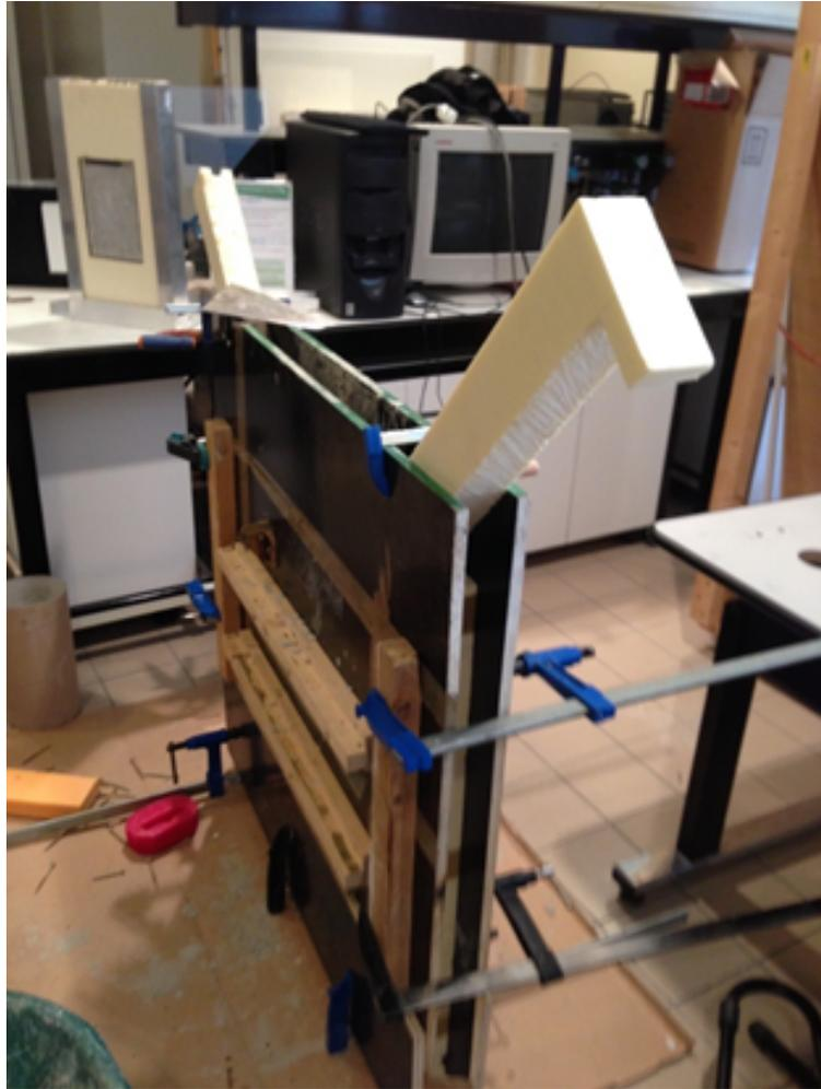
Figure 2.2 : Moule de la paroi stockeuse
