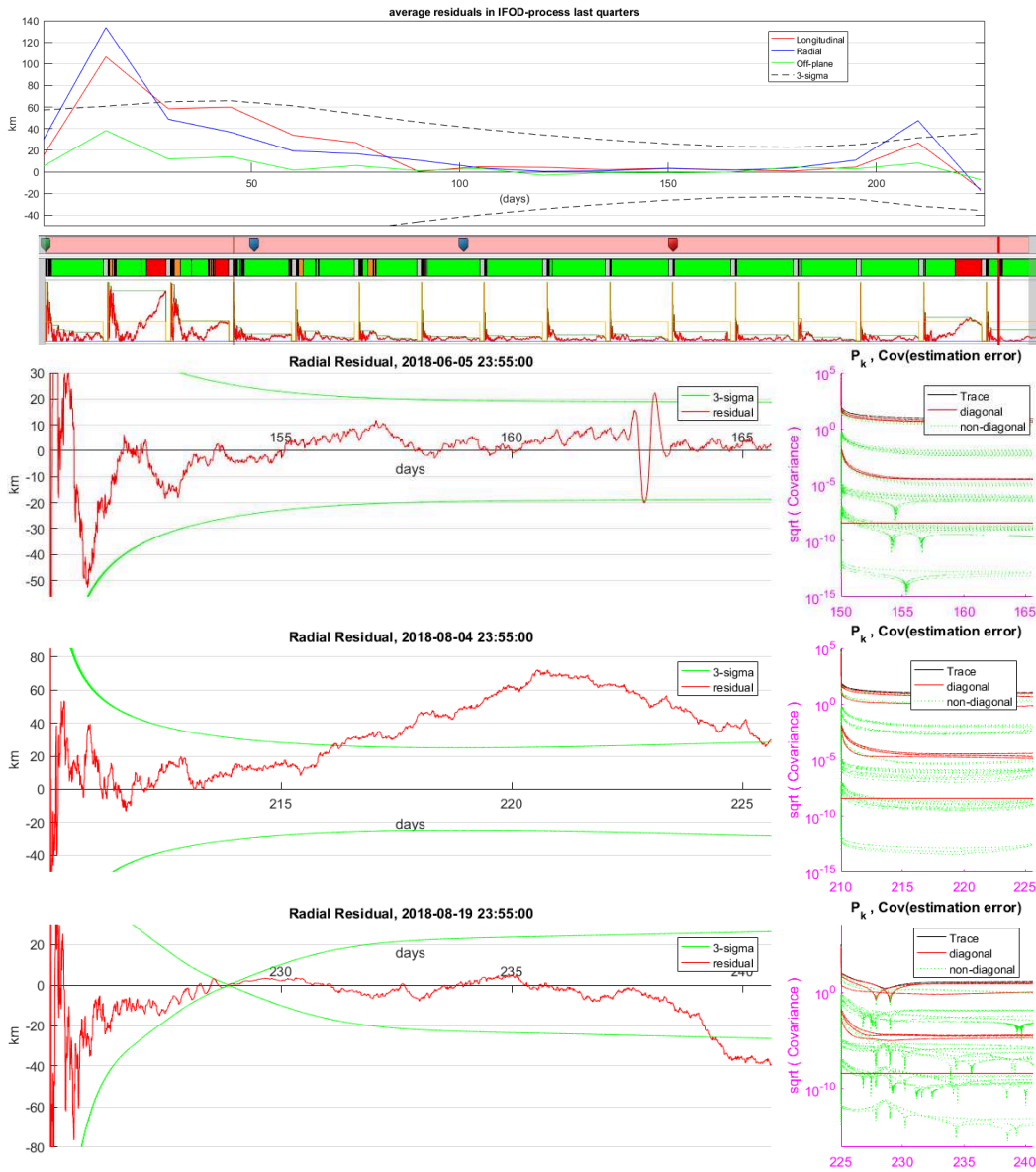
FIGURE 6.8 – Série UKF-5FGB. Haut : synthèse sur tout le scénario de vol. Milieu et bas : détails du filtrage aux dates 150, 210 et 225, Résidu majorant (à gauche), évolution de la covariance (à droite). Remarque : au jour \sim 228 , l'enveloppe 3\sigma se resserre jusqu'à environ \pm 500\text{ m} ! Pour mémoire, \sigma_{opt} = 0.2'' .
