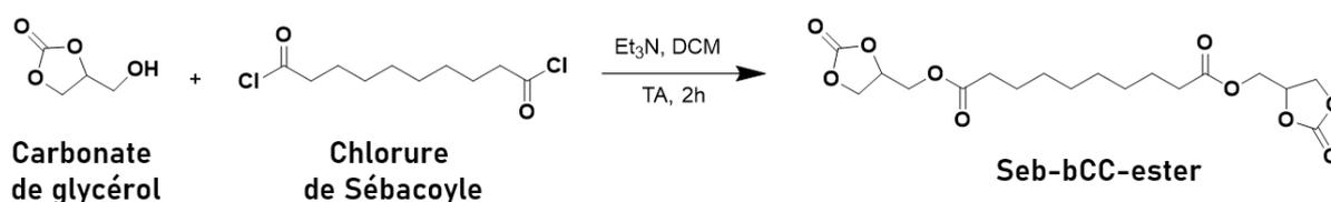
Figure 9. Synthèse du Seb-bCC-ester à partir du carbonate de glycérol.
