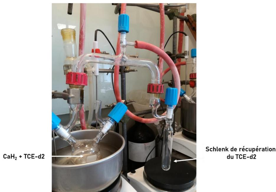
Figure 1. Montage de cryodistillation.
