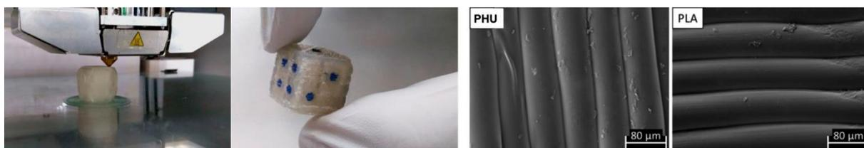
Figure 29. Impression 3D d'un système PHU semi cristallin (gauche) et comparaison entre le positionnement des brins PHU et ceux en PLA (droite). Extrait de Schimpf *et al.*<sup>129</sup>
