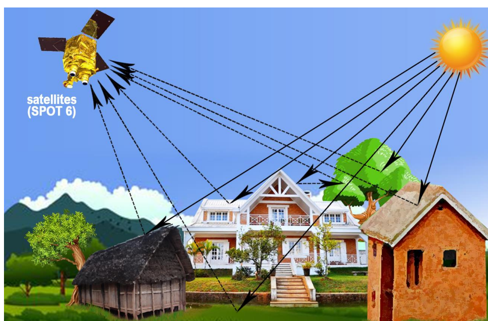
Figure 22 : L'acquisition des images satellites (Spot) par télédétection passive (Andriatsiaronandroy, 2018)
