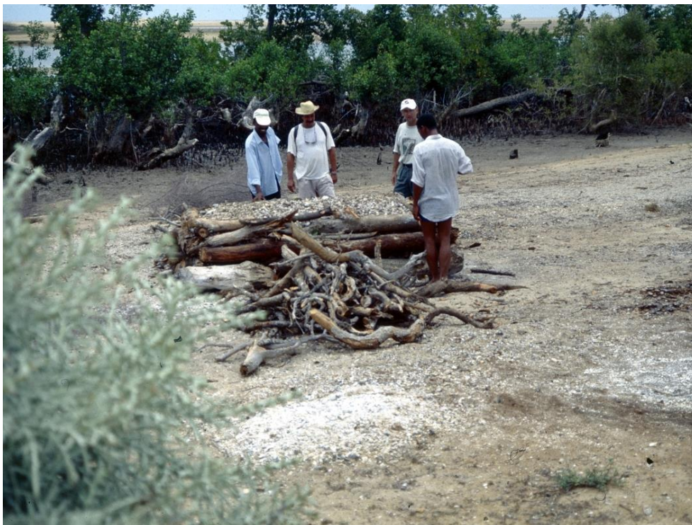
Figure 145 : Fabrication de chaux à Songeritelo. Les bois proviennent des palétuviers d'Ambodrolava. (Lebigre, 1989)
