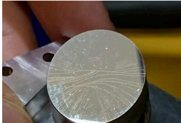
FIGURE D.11: État du miroir secondaire du télescope de PicSat après un test de cyclage thermique réalisé sous cloche à vide. L'aluminure du miroir est fortement endommagée, comme en témoignent les rayures bien visibles.
