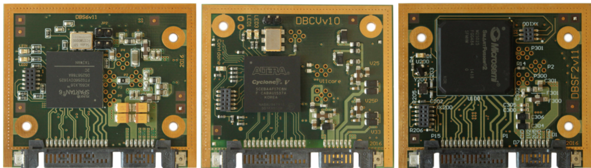
(a) Carte fille avec FPGA Xilinx Spartan 6 (b) Carte fille avec FPGA Intel Cyclone V (c) Carte fille avec FPGA Microsemi SmartFusion2
