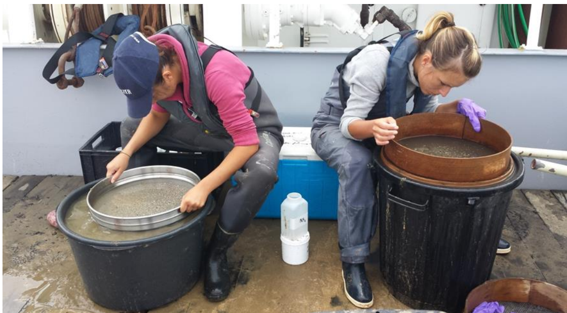
Figure II. 31 : Phase de tamisage des échantillons dans un bain d'eau de mer.
