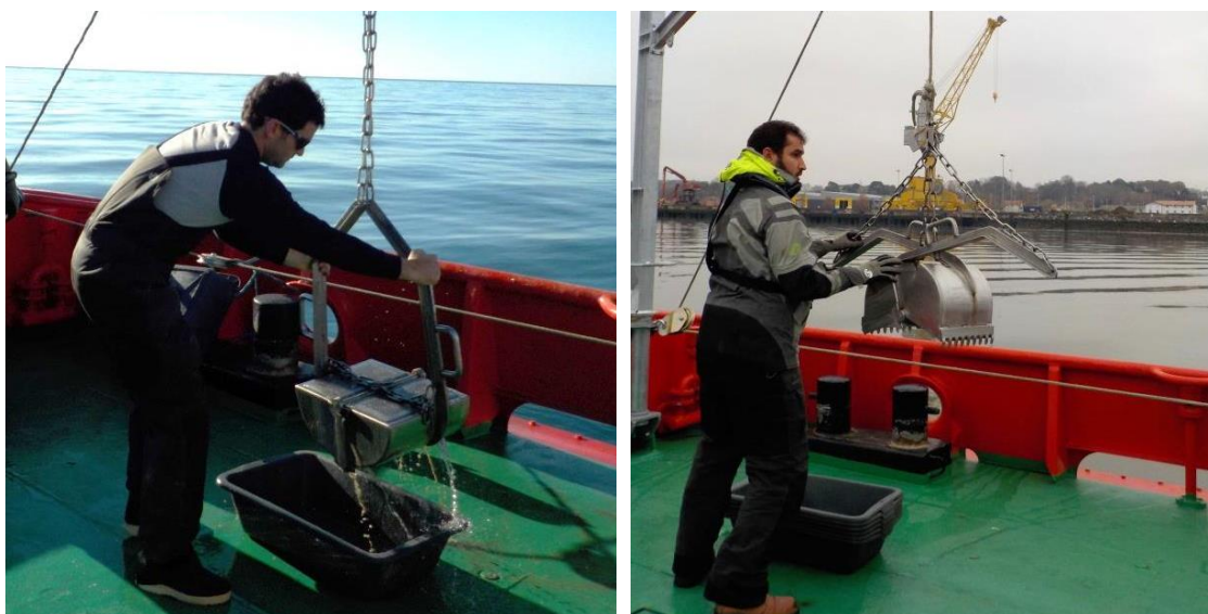
Figure II. 30 : Benne de prélèvements de type Van Veen.
