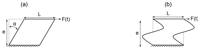
FIGURE 1.13: Limitation des essais dynamiques hors résonance. À gauche, le champ de déformation est uniforme, la longueur d'onde \lambda est bien supérieure à l'épaisseur e , \lambda \gg e . À droite, la longueur d'onde est égale à l'épaisseur, \lambda = e . Le champ de déformation qui en résulte est non-homogène.
