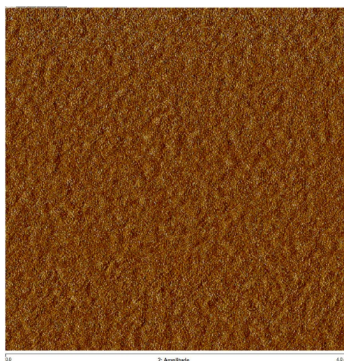
FIGURE 3.51 – Image AFM de la surface de l'oxyde de silicium avant gravure
