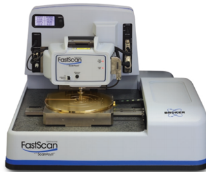
FIGURE 2.28 – Dispositif expérimental AFM "Dimension Fastscan"
