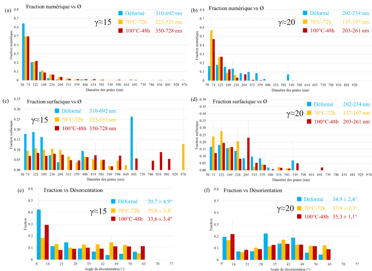
Figure 5. 29 : Fractions numériques (a, b) et surfaciques (c, d) des grains en fonction de leur diamètre pour l'alliage 0,4% SC déformé par HPS avec \gamma \approx 15 (a, c) et \gamma \approx 20 (b, d) ; avant (bleu), après recuit à 70^\circ\text{C} pendant 72h (jaune) ou après recuit à 100^\circ\text{C} pendant 48h (rouge). Ainsi que (e, f), les fractions de joints de grains en fonction de leur désorientation.
