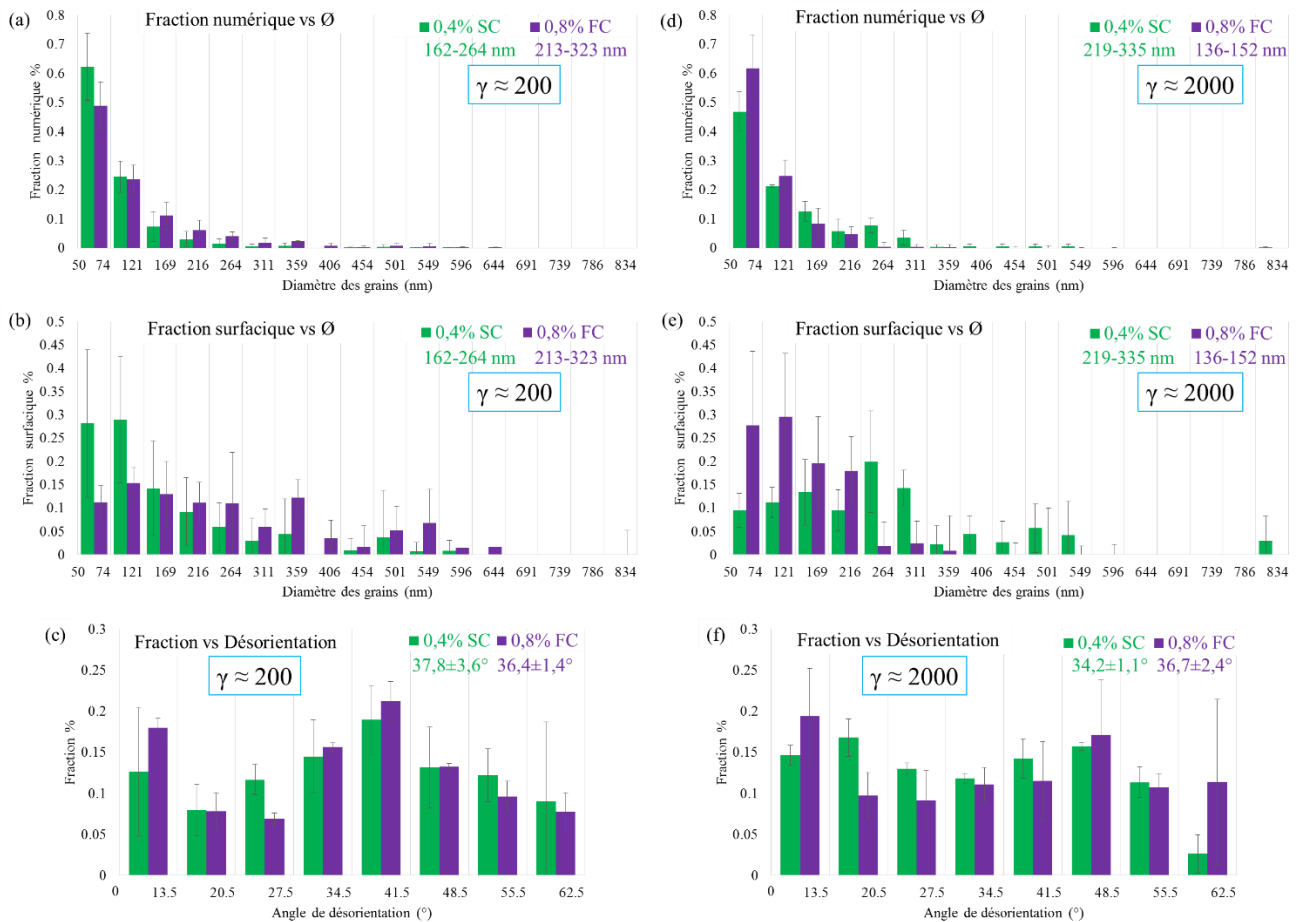
Figure 4. 14: Fractions de grains en fonction de leur diamètre pour les états déformés à \gamma \approx 200 (a) et à \gamma \approx 2000 (d). Fractions surfaciques des grains en fonction de leur diamètre pour les états déformés à \gamma \approx 200 (b) et à \gamma \approx 2000 (e). Fractions de joints de grains en fonction de leur désorientation pour les états déformés à \gamma \approx 200 (c) et à \gamma \approx 2000 (f). Les moyennes de tailles de grains et des angles de désorientation sont indiquées en haut à droite des graphiques.
