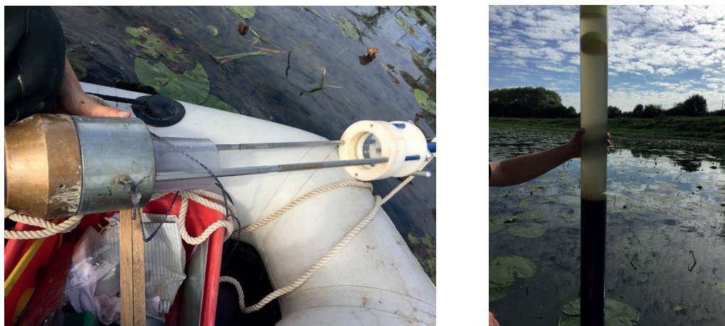
Figure 12 : Gauche : carottier d'interface Küllenger ; droite : carotte de sédiment. Q. Cuenot et C. Schaal, 2017
