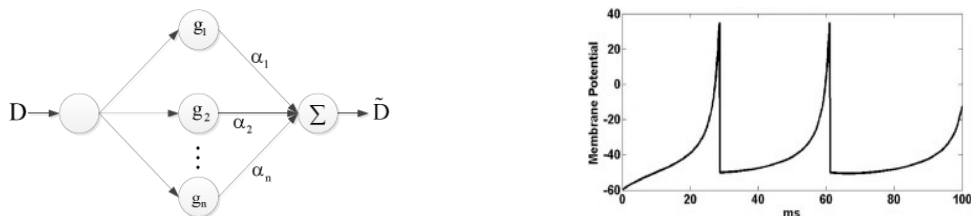
FIGURE 2.3 – Image de gauche issue de (JEMAI et al. 2015) illustrant l'architecture d'un réseau d'ondelettes, avec (g_i) les versions dilataées et déplacées des fonctions d'ondelettes. Images de droite issue de (TAVANAËI et MAIDA 2017) illustrant la réponse d'un neurone impulsif
