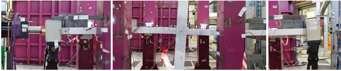
Figure 1.67 – Absence de rotation autour de l'axe Y de la poutre de rive 1, bloquée par le vérin, contrairement à la poutre de rive 2 libre de tourner sur ses appuis
