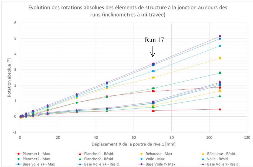
Figure 1.60 – Valeurs maximales et résiduelles de l'angle de rotation absolu des éléments de structure à 8,5cm de la jonction (inclinomètres à mi-travée)
