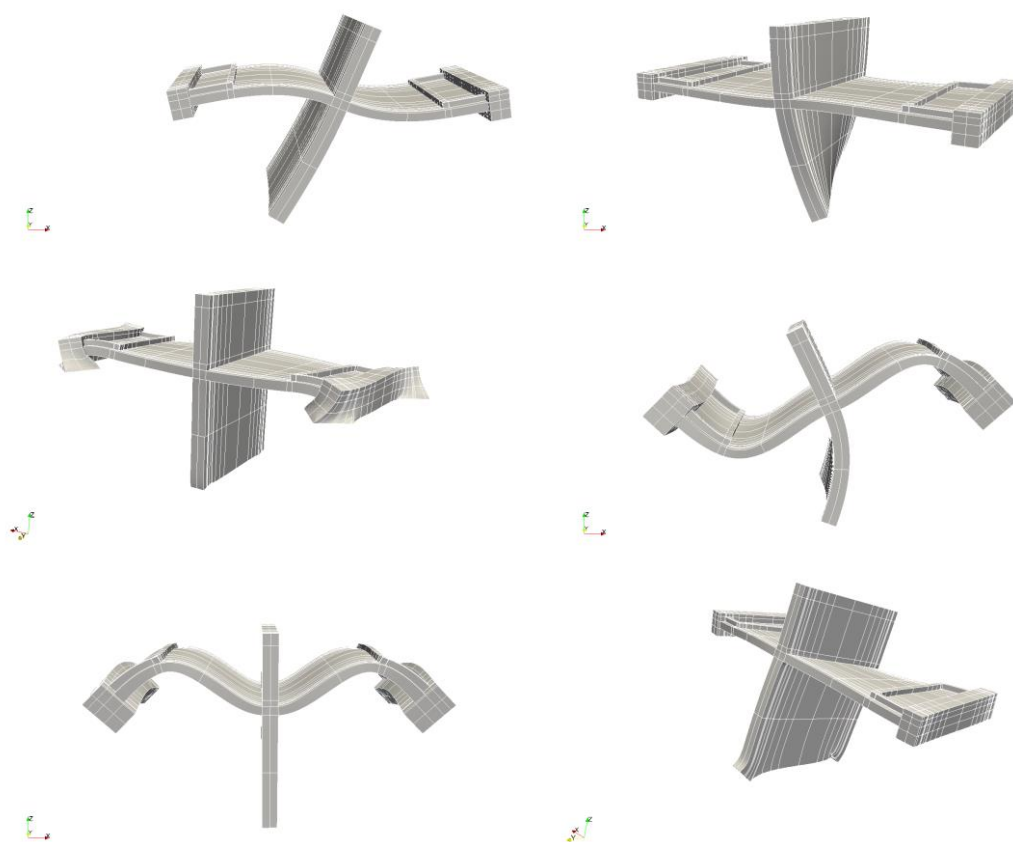
Figure 0.3 – Vues des déformées modales du modèle A de la maquette flexion lors de l'essai 7. De gauche à droite puis de haut en bas, par fréquence croissante : mode de flexion du voile, mode de torsion du voile, modes des poutres de rives et poteaux, mode de flexion du voile et du plancher (asymétrique), mode de flexion du plancher (symétrique), mode de cisaillement.
