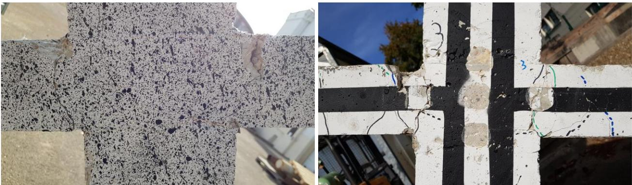
Figure 1.81 – Fissuration du pignon côté Y- (à gauche) et Y+ (à droite) à l'issue de l'ensemble des runs
