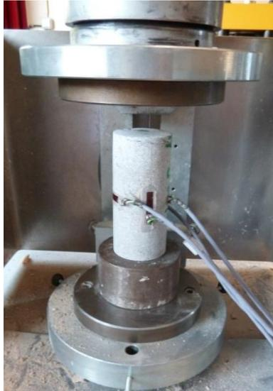
Figure 3. 14 : Essai de compression uniaxiale sur une éprouvette de moellon équipée de jauges
