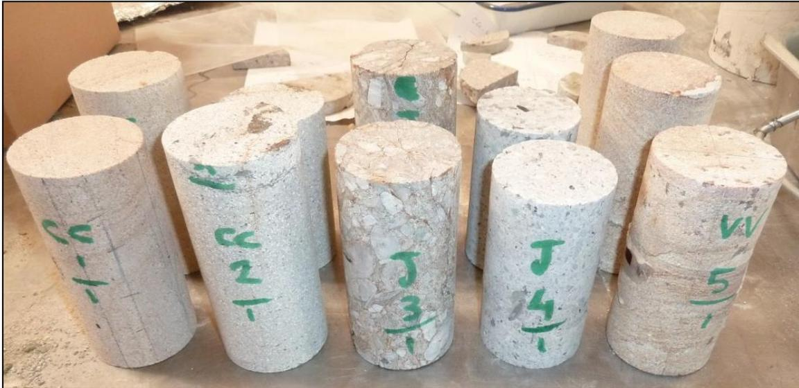
Figure 3. 10 : Eprouvettes de moellons réalisées pour les essais de compression
