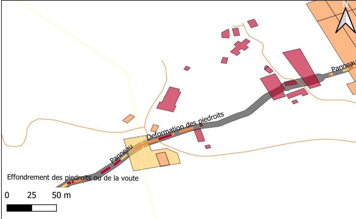
Figure 4.8 : Reprise des éléments de la Figure 4.7 et ajout des désordres pondérés du ruisseau couvert Les Forges - 1, Bessèges
