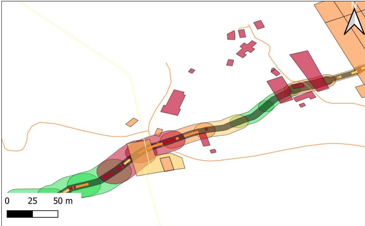
Figure 4. 9 : Reprise des éléments de la Figure 4.8 et ajout des zones d'effondrement potentiel colorées en fonction de la note de risque obtenue pour ces zones. Ruisseau couvert Les Forges - 1, Bessèges
