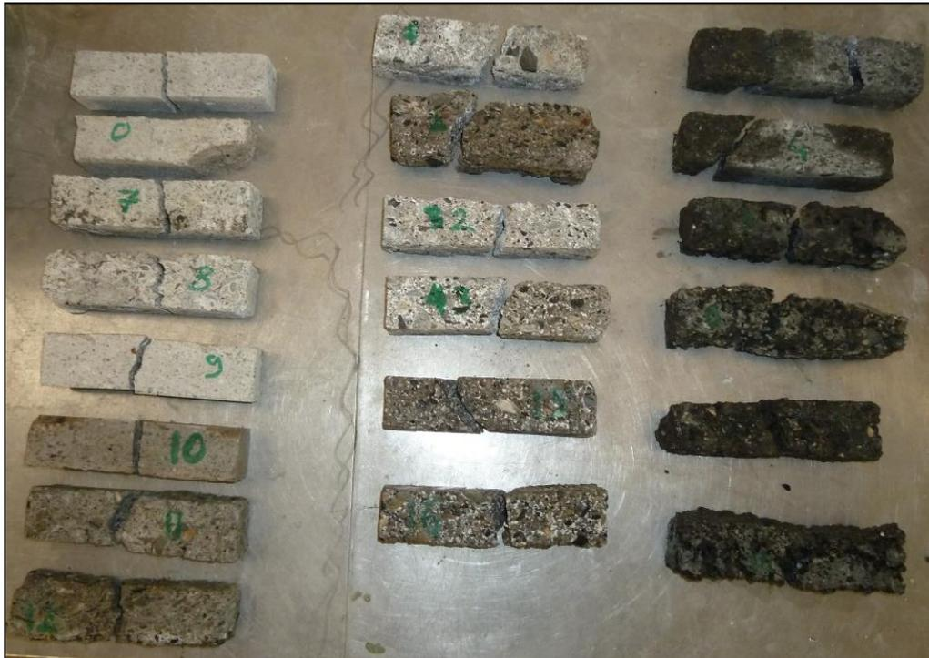
**Figure 3. 12 : Eprouvettes de joints réalisées pour les essais de flexion**
