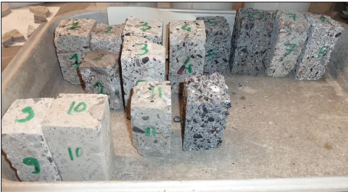
Figure 3. 11 : Eprouvettes de joints réalisées pour les essais de compression
