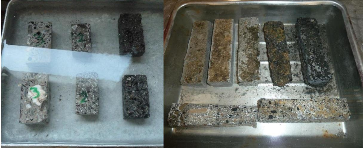
Figure 3. 13. Immersion des échantillons de joint
