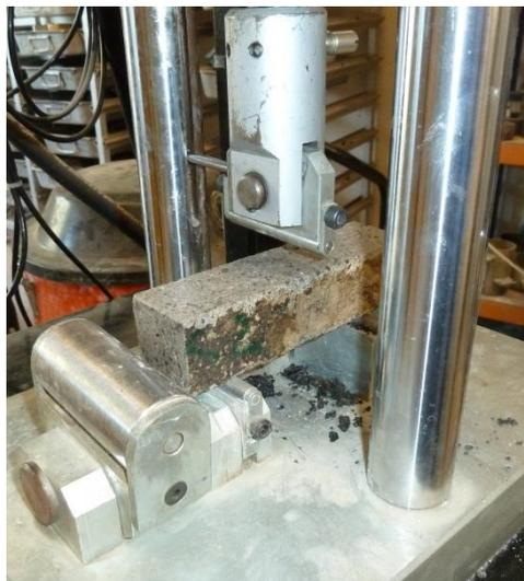
Figure 3. 15 : Essai de flexion trois points sur une éprouvette de joint
