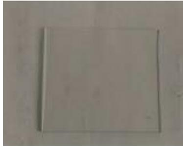
*Figure 4.1.1—2 : Photographie d'une plaque d'oxyde d'indium-étain (ITO) commerciale
