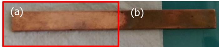
**Figure 4.2.4—4** : Photographie d'une plaque de cuivre (a) – avant et (b) – après nettoyage à l'acide nitrique dilué (0,1 M)
