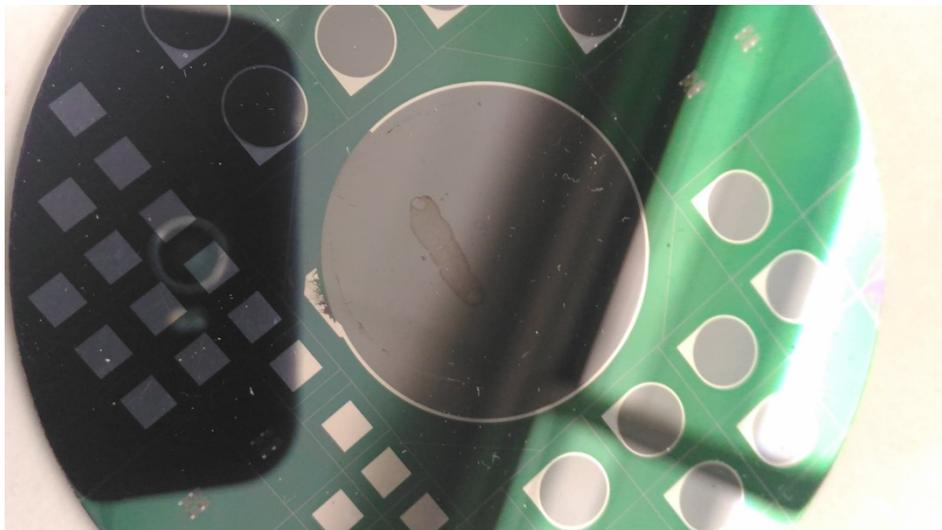
**Figure 4.1.2—2** : Photographie d'une plaque 10 x 10 cm de *p*-Silicium dopé bore fournie par l'équipe partenaire de la BSU
