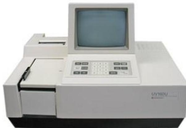
**Figure 4.3.8—1** : Vue général du spectrophotomètre UV-Visible UV-160A SHIMADZU
