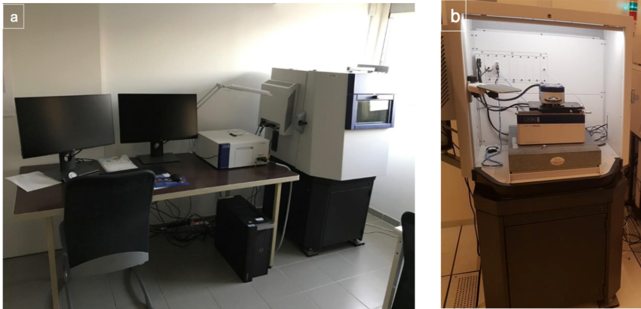
Figure 4.3.5—1 : (a) – Vue d'ensemble de l'AFM Asylum Oxford MFP3D disponible au C2MA de l'IMT Mines Alès ; (b) – photographie de l'unité de mesure de l'AFM en fonctionnement
