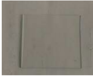
Figure 4.1.1—2 : Photographie d'une plaque d'oxyde d'indium-étain (ITO) commerciale fournie par le partenaire BSU
