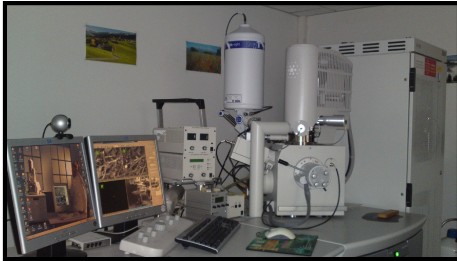
Figure 4.3.6—4 : Photographie du MEB utilisé au C2MA
