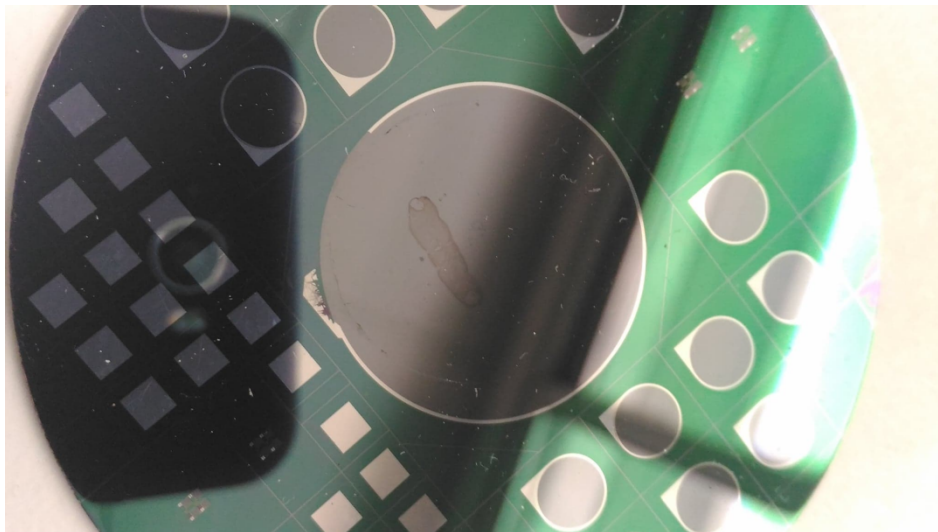
Figure 4.1.2—2 : Photographie d'une plaque 10 x 10 cm de p -Silicium dopé bore fournie par l'équipe partenaire de la BSU
