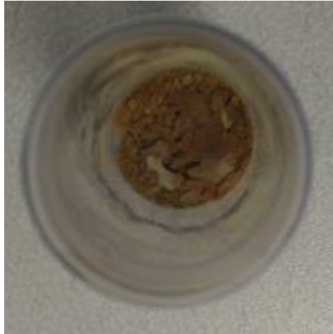
Figure 4.2.4—3 : Photographie du précipité de cyanure aurique obtenu après filtration
