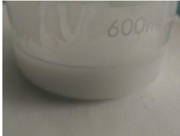
Figure 4.2.2—8 : Photographie du gel de boehmite permettant la synthèse de la \gamma -alumine
