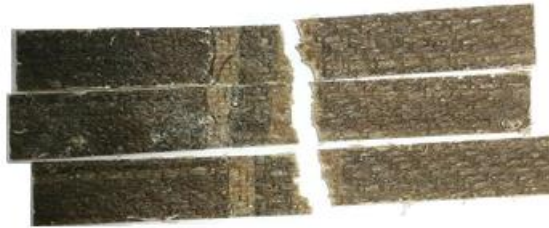
Figure III-57 : Mode de rupture obtenu lors des essais de cisaillement interlaminaire (ASTM D 3165) sur éprouvettes de composite bio-sourcé.
