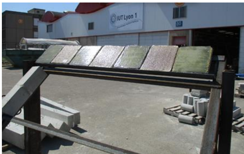
Figure II-9 : Dispositif de vieillissement naturel à l'extérieur du laboratoire LMC 2 à Lyon.
