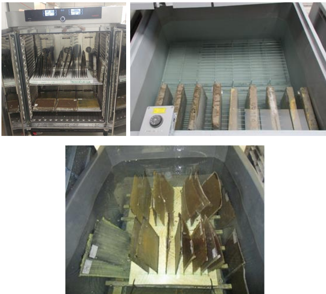
Figure II-11 : Vieillissement des échantillons dans les chambres climatiques et bacs d'eau à température constante.
