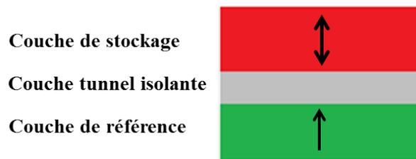
Figure 1.9: Empilement schématique de trois couches rentrant dans la configuration d'une MTJ
