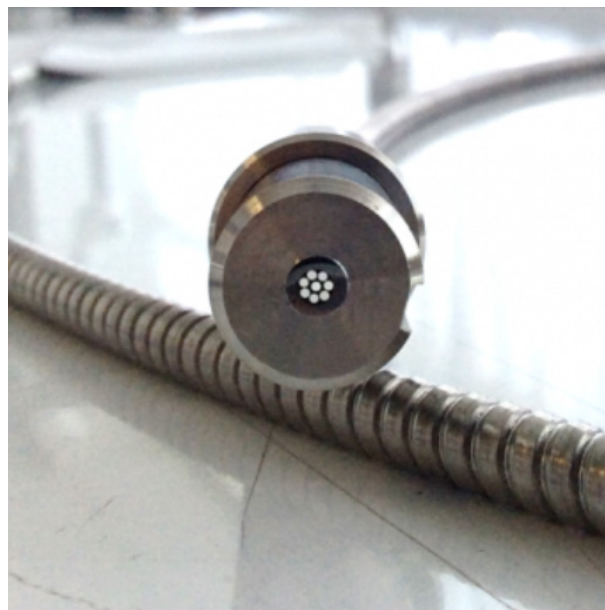
FIGURE 4.8 – Photographie du deuxième faisceau de fibre, montrant la disposition circulaire des fibres et la gaine externe en acier inoxydable. Cette image a été prise par Le Verre Fluoré, et leur sert actuellement d'exemple de fibres fabriquées sur plans.
