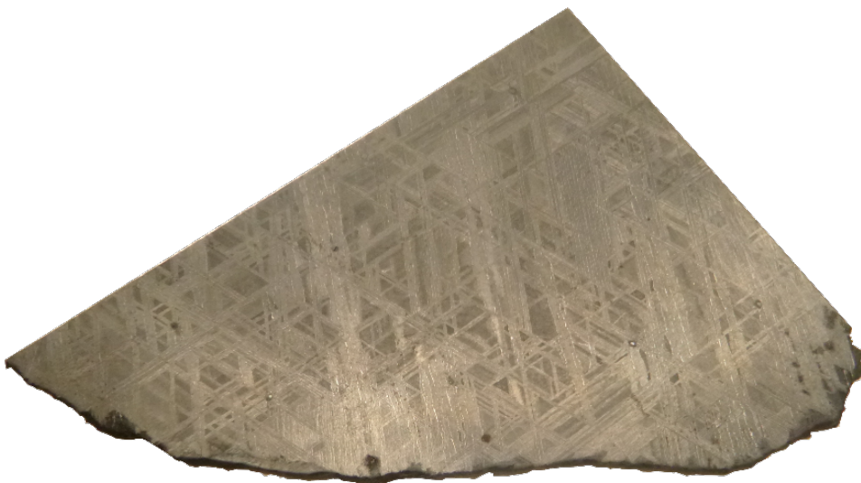
FIGURE 2.4 – Photographie d'une tranche de la météorite de fer Gibeon montrant la structure de Widmanstätten
