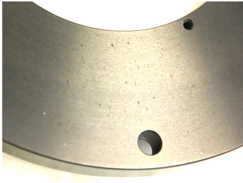
FIGURE 5.9 – Photographie de la bride de maintien de la fenêtre saphir montrant les "impacts" dus à l'anodisation noire sur la surface (la luminosité et le contraste de l'image ont été augmentés afin de mieux discerner les traces d'acide).
