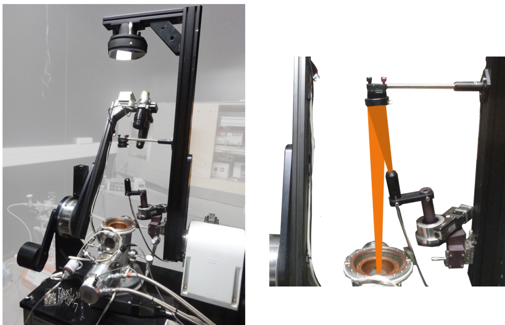
FIGURE 4.1 – Gauche : photographie de SHINE en mode Gognito, le miroir additionnel est visible, accroché au bras d'éclairage. Droite : détail du miroir additionnel permettant la focalisation de la lumière incidente.
