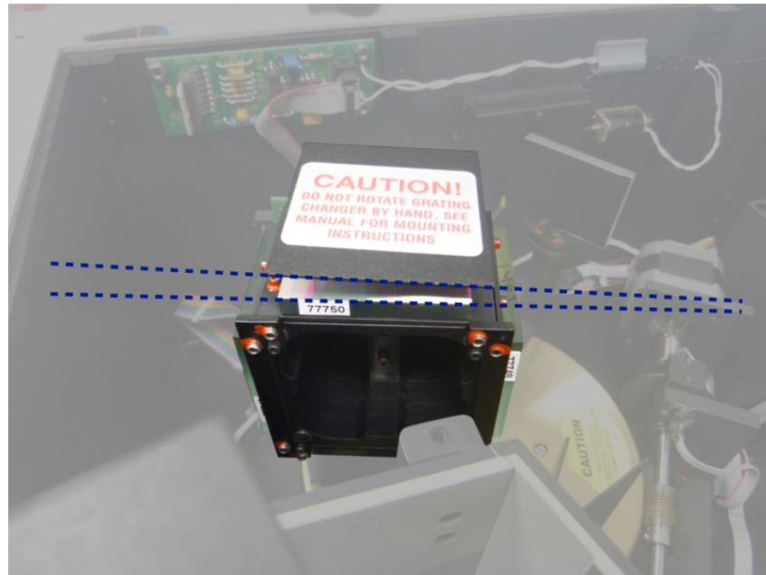
FIGURE 4.5 – Photographie de l'intérieur du monochromateur montrant la tourelle ayant mal positionné le réseau. Les deux droites en pointillés marquent la position du réseau supérieur par rapport à l'horizontale. Dans de bonnes conditions, ces droites devraient être parallèles.
