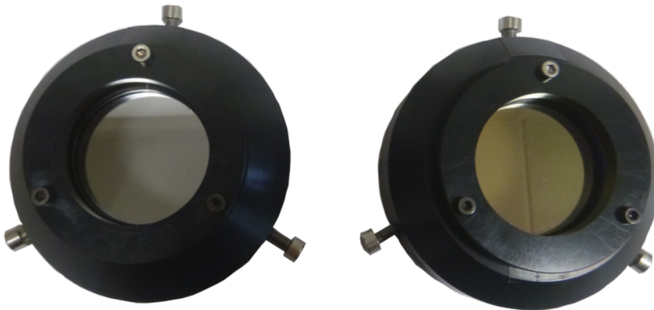
FIGURE 4.30 – Photographie des polariseurs visible (gauche) et infrarouge (droite) dans leur monture. Les vis non noircies marquent l'axe des polariseurs.
