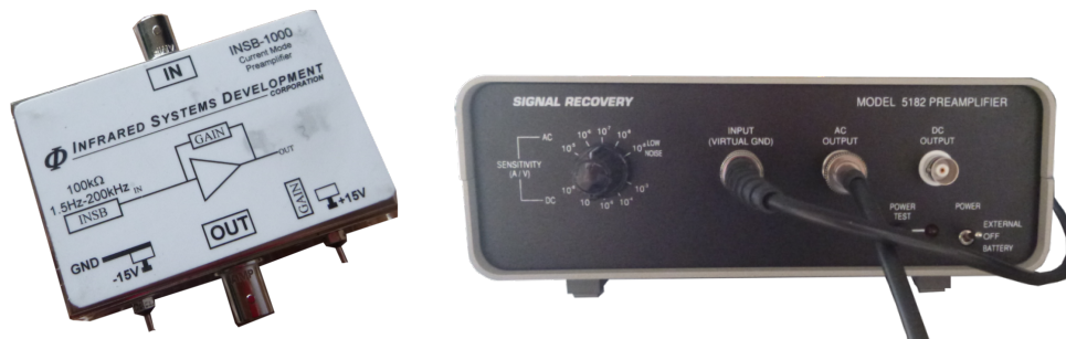
FIGURE 4.26 – Préamplificateur des détecteurs infrarouge (gauche) et visible (droite) de SHADOWS. Les échelles entre les deux préamplificateurs ne sont pas respectées.
